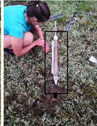
*Principe de prélèvement de sédiment en pré salé*
